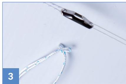
Retirer les fils de traction de la platine et les repositionner sur la surplatine afin de permettre sa mise en place.
