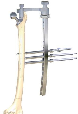
Mesurer les longueurs des vis de verrouillage à l'aide de la **jauge de profondeur (C4A/170)** passée au travers des canons-guides.
